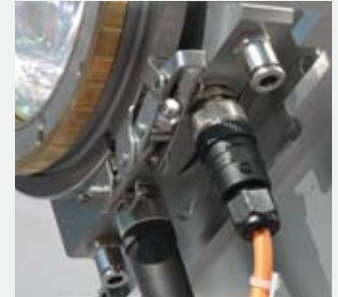
护镜监测系统的电气连接
