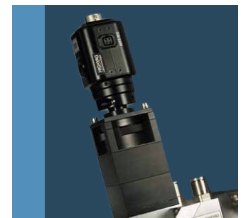
可视系统的CCD相机
