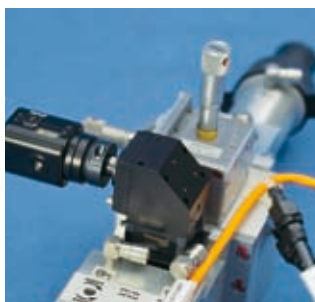
可视系统的CCD相机
