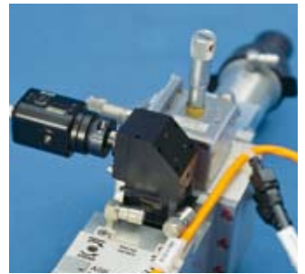
可视系统的CCD相机
